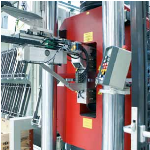
Das Laden und Entladen der Prüfmaschine
