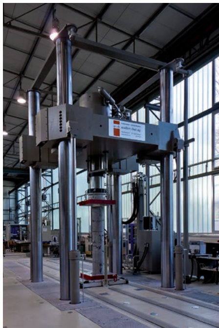
Bild 1. Neue 10-MN-Säulenprüfmaschine der TU Dresden (Foto: C. Dittrich)
