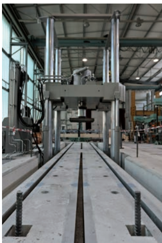
Bild 6. Bau des Spannbetonbalkens Fig. 6. Construction of prestressed concrete beam
