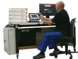
Hochauflösendes digitales Mehr-Kreis Mess- und Regelsystem für die Kraft-Weg- und Dehnungsregelung im geschlossenen Regelkreis für statische und dynamische Versuche bis 150 Hz. Das System kann auf beliebige Anzahl Regelkreise ausgebaut werden. Mit bis zu 13 Regel- und Messkanäle pro Kreis und einem Regeltakt von 8 kHz auf jedem Regelkreis. Synthesizer-Funktionen wie Rechteck, -puls, Dreieck, -puls, Sinus und Kurve erhältlich.
