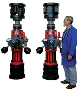
Gelenke schalten Fluchtfehler beim Einsatz der Prüfzylinder aus und schützen diesen und die Kraftmessdose vor schädlichen Querkräften und Momenten.
