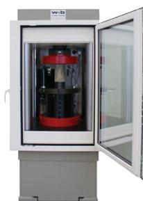
Konzipiert für Druckversuche an Gesteinen gemäss EN 772-1. Die Maschine ist ausgerüstet mit einer Klimakammer zur Simulation von Umgebungsbedingungen zur Bestimmung der Druckfestigkeit unter realen Bedingungen gemäss den relevanten Normen. Isoliert mit Spezialglas. Drei Türen um die Maschine herum für eine bequeme Versuchsvorbereitung und Installation der Vorrichtungen und Messsysteme.
