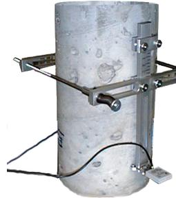
Zur genauen Bestimmung der Materialeigenschaften wie E-Modul ist neben dem Prüfsystem eine genaue Längenänderungsmessung der Probe erforderlich. Erhältlich sind verschiedene und präzise Dehnungsaufnehmer mit Anschluss an die Prüfsoftware PROTEUS zur Bestimmung
