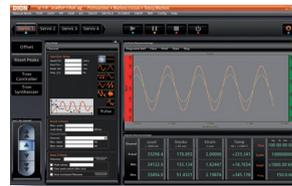
Dieses Anwendungsmodul der w+b Materialprüfsoftware DION7 Software ist speziell konzipiert für monotone statische und dynamische Ermüdungsversuche. Das Softwaremodul dient der Erstellung von einkanalen sowie synchronisierten mehrkanaligen Versuchen mit einer vordefinierten Frequenz und Schwingung (regelmässig wiederkehrende Bewegung) pro Kanal. Es stehen Rampe, Sinus, Dreieck, Rechteck, Sägezahn und Puls-Schwingungen zur Verfügung.
