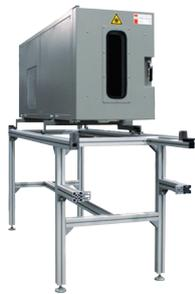
Die Klimakammern erlauben ein Kühlen und Heizen sowie optional mit Feuchtigkeit. Modelle mit verschiedenen Prüfkammergrößen und Temperaturbereichen sind erhältlich. Die Klimakammern können fix in die Prüfmaschine eingebaut werden oder auf einer Vorrichtung mit Rollen zum einfachen Ein- und Ausfahren aus dem Prüfraum. Die Kammern bieten eine konstante und genaue Temperaturregelung mit Sensoren im geschlossenen Regelkreis.
