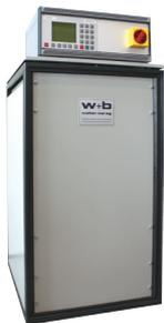
Mit integriertem Hydraulikaggregat zur Druckölversorgung der Prüfmaschinen. Der Digitalregler DIGICON 2000 kann platzsparend auf dem Schrank platziert werden. Im Schrank kompakt integriert sind Öltank, Doppel-Pumpe, Filter, Druckbegrenzungsventile, Öl-/Luftkühler, Servoventil sowie die elektrische Steuerung. Auch erhältlich mit Be- und Entlastungsventilen für manuell gesteuerte Maschinen.
