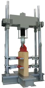
Die Maschinen der Serie SDM können mit horizontalen Prüfzylindern ausgerüstet werden für die biaxiale Prüfung von Mauerwerken nach EN 1052 sowie zur Bestimmung der Druck-, Scher- und Biegefestigkeit unter vordefinierten statischen vertikalen Druckkräften. Optional können die Maschinen mit einem Einfahrwagen ausgerüstet werden, sodass die Prüfteile bequem mit
