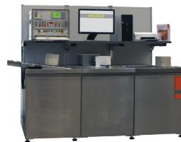
Für ein genaues, effizientes und produktives Prüfen mit ergonomischen Arbeiten. Die Mess- und Wiegestation erlaubt eine hochgenaue Bestimmung von Gewicht und Abmessungen von Würfeln und Zylinder mittels einer eingebauten Präzisionswaage und digitaler Messeinrichtung zum Messen von Kantenlänge oder Durchmesser. Die Proben werden auf einfachste Weise über eine Rollbahn
