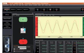
Das Modul visualisiert bei Mehrkanalanwendungen die Regelkanäle in einer Versuchsmatrix, so dass selbst bei komplexen Versuchen eine übersichtliche Versuchsprogrammierung gewährleistet wird.
