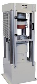
Diese Maschinen bestehen aus einem freistehenden Lastrahmen, welcher mit einem 19" Steuerpult oder in Verbindung mit Mess- und Wiegestation betrieben werden kann. Die Prüfmaschinen finden hauptsächlich Verwendung als Ausführung mit hochpräziser Kraftmessdose, als Kombination mit Mess- und Wiegestation oder wenn noch zusätzliche andere Prüfmaschinen mit
