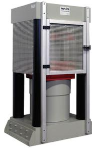
Diese Prüfmaschinen sind geeignet für die Druckfestigkeitsprüfung von Proben aus hochfestem Beton, Gestein und für Ziegel aller Festigkeitsklassen, für spröden, plötzlichen Bruch nach EN 772-1. Die Prüfraumen in 4-Säulen-Konstruktion zeichnet sich durch eine sehr hohe Steifigkeit aus, was die im Prüfraum gespeicherte Verformungsenergie minimiert. Die obere Druckplatte ist speziell entwickelt für hohe Kräfte und hohe Bruchreaktionen.
