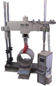
Diese Prüfmaschine sind speziell entwickelt zur Prüfung von Kanalisations- und Betonrohren bis 2000 mm Durchmesser und 2500 mm Länge nach EN 1916. Die Maschinen sind erhältlich mit verstellbarer oberer Querhaupt, für ein schnelles und genaues Positionieren: mechanische oder hydraulische Verstellung via Langhubzylinder mit mechanischer
