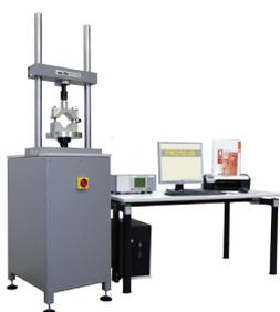
Diese Prüfmaschine ist speziell konzipiert für CBR- und Marshallversuche gemäss international relevanten Normen. Diese kompakte Maschine verfügt über ein integriertes Hydraulikaggregat im Sockel. Automatischer Versuchsablauf im geschlossenen Regelkreis. Zahlreiche Vorrichtungen sind erhältlich wie Marshall Stability Mould, Spaltzugvorrichtung für Marshallproben, Schervorrichtung für Asphaltbohrkerne, CBR Schalen usw.
