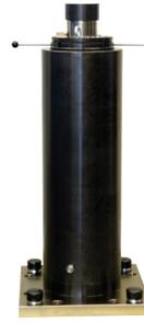
Wir liefern Druckzellen nach Ihren Zielvorgaben für die normgerechte Prüfung oder für Forschungszwecke. Zusätzlich sind Aufbauten für Verformungsexperimente, Permeabilitätsbestimmungen, Ultraschalllaufzeitmessungen, akustische Emissionen und innenliegende Sensorik erhältlich. Das optional erhältliche Adaptersystem ermöglicht eine optimale Anpassung des Druckstempels an jeweiligen Probendurchmesser mit wenigen Handgriffen.
