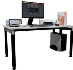
Hochauflösender Digitalregler für die Kraft-, Weg-, und Dehnungsregelung im geschlossenen Regelkreis mit Schnittstellen für den PC-Betrieb mit Windows Prüfsoftware DION. Diese leistungsstarke digitale Regel-, Mess- und Steuerelektronik mit 1000 Hz / 5000 Hz synchronem Regel- und Messwertfassungstakt mit Echtzeitverarbeitung aller Kanäle ist speziell konzipiert für die statische und dynamische Materialprüfung.
