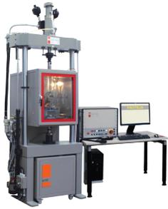
Im Bereich der Gesteinsprüfung bietet w+b Prüfmaschinen bis 10'000 kN an. Diese zeichnen sich durch eine enorme Steifigkeit aus und sind ideal für uneingeschränkte Druck-, Triaxial-, Biege-, indirekte Zug-, Bruch- und Kriechversuche. Die Triaxialzellen mit oder ohne Heizung können mit integrierten Kraft-, Druck- und Deformationsmesssystemen und weiteren Komponenten nach Ihren Wünschen ausgerüstet werden.
