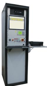
Die Steuerschränke sind modular ausrüstbar entsprechend der zu steuernden Prüfmaschinen und gemäss Ihren Anforderungen. Im Oberer Teil können alle notwendige Peripheriegeräte wie PC, Digitalregler DIGICON 2000, elektrische Steuerung mit Notschalter usw. ergonomisch eingebaut werden. Der Drucker kann auf einem schwenkbaren Arm platziert werden. Das Hydraulika-
