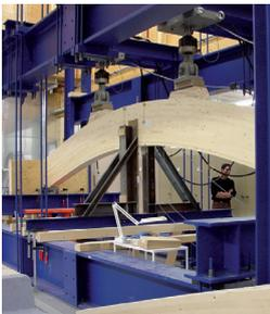
Zur flexiblen Gestaltung von Versuchen für experimentelle Untersuchungen mechanischer Eigenschaften des Trag- und Verformungsverhalten von Bauteilen wie Bohrpfehlen, Tragwerken, kompletten Decke-Wand-Knoten im Mauerwerksbau, ganzen Brückenteilen u.a. liefert w+b Prüfportale und Spannfelder, welche in enger Zusammenarbeit mit dem Kunden projektiert werden. Ebenso
