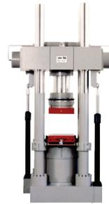
Die Serie DV zeichnet sich durch die höhenverstellbare Quertraverse aus. Die Passivklemmung der Traverse kann hydraulisch entspannt und dann kann die Traverse mittels zwei seitlich angebrachten Hydraulikzylindern exakt in der Höhe positioniert werden. Dies ermöglicht ein Prüfen unterschiedlichster Probenabmessungen ohne Verwendung von Zwischenplatten. Die Prüfmaschinen werden mit 19" Steuerpult und DIGICON 2000 betrieben.
