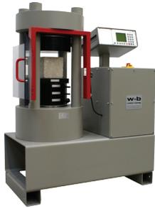
Die Serie D5 sind kompakte Druckprüfmaschinen in einer stabilen 4-Säulen-Konstruktion. Im Maschinensockel integriert ist ein Hydraulikaggregat mit Servoventil und Luft-Wasserkühlsystem. In Verbindung mit Digitalregler DIGICON 2000, Streifendrucker und Digitalanzeige für automatische Versuchsabläufe im geschlossenen Regelkreis. Zahlreiche Vorrichtungen und
