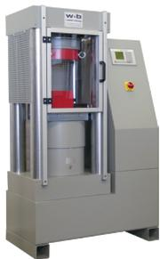
Die Prüfmaschinen der Serie DC sind kompakte und sehr ergonomische Druckprüfmaschinen in einer stabilen 4-Säulen-Konstruktion. Im Unterteil des seitlichen Gehäuses ist die komplette Ölversorgung mit Servoventil, Feinstfilter, Öl-Luftkühler etc. eingebaut. Im oberen Teil integriert ist der Digitalregler DIGICON 2000 für vollautomatische Versuchsabläufe im geschlossenen Regelkreis und optional der Streifendrucker.
