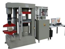
Ein Prüfraum kann mit anderen Prüfmaschinen und einem Steuerpult kombiniert werden. Die Kombinationen sind sehr kostengünstig und platzsparend im Labor. Ein Steuerpult kann bis zu 4 Maschinen steuern. Dabei können dieselbe Elektronik, Digitalregler und Prüfsoftware verwendet werden. Zudem ist nur ein Hydraulikaggregat notwendig für mehrere Prüfmaschinen.
