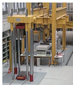
Als kundenspezifische Maschinen können wir Druckprüfmaschinen liefern für Kapazitäten bis 10 MN oder höher. Diese Prüfraumen sind konstruiert und gefertigt gemäss den Kundenbedürfnissen. Diese Prüfmaschinen zeichnen sich durch grössere Prüfraume aus, im speziellen mehr lichte Weite zwischen den Säulen sowie Prüfraumhöhe. Dies erlaubt einen universellen Einsatz der Prüfmaschinen für eine Vielzahl von Versuchen und Proben.
