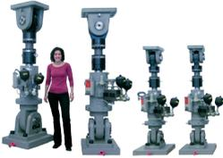
Für die statische und dynamische Bauteilprüfung im Schwell- oder Wechsellastbereich stehen Gleichgang, Hohlkolben-, Differential-, sowie Axial-Torsional-Prüfzylinder zur Verfügung. Die Zylinder können mit Kraftmessdosen oder Differenzialdruckaufnehmern, Servoventileinheiten mit Druckspeichern, Befestigungsflanschen, Druckplatten, Gelenkaugen mit Gabelkopf, Kardangelenken und Anschlussventileinheiten für den Betrieb von mehreren Zylindern.
