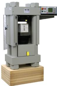
Diese sehr einfache und kostengünstige Modelle können als stand-alone Maschinen mit Hydraulikaggregat neben der Maschine oder an ein bestehendes Prüfsystem angeschlossen werden. Die Serie C zeichnet sich durch eine stabile 4-Säulen-Konstruktion mit einfach wirkendem Prüfzylinder. Erhältlich als manuell gesteuerte Maschine mit Digitalanzeige DIGICON 1000 oder mit Servoventil und Digitalregler DIGICON 2000 für Versuche im geschlossenen Regelkreis.
