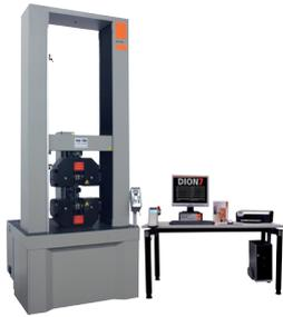
Zur rationellen Durchführung von statischen und quasistatischen Versuchen an unterschiedlichsten Proben und Bauteilen. Sie werden hauptsächlich zur Prüfung von Gummi, Kunststoffen, Folien, Textilien, Klebstoffen, Papier, Lebensmittel, Schaumstoffen, Holz, Drähten und anderen Werkstoffen sowie medizinischen, elektronischen und anderen Bauteilen, Metallproben, Verbindungselementen und Verbundwerkstoffen im Kraftbereich von 1 bis 600 kN.
